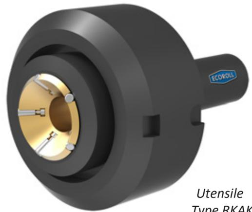
Gli utensili speciali a rulli multipli (Type RP, RK, RKAK) sono, invece, appositamente relizzati per la rullatura di superfici non cilindriche, ad esempio le conicità interne ed esterne.
