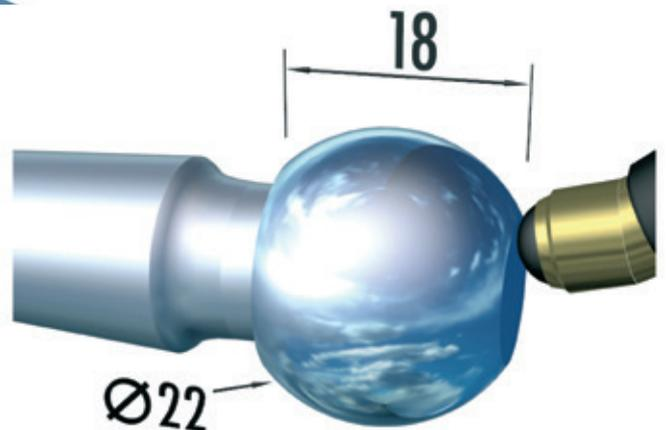
*Lavorazione di bottone automatico con Type HG6.*
