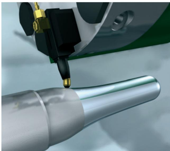
*Lavorazione profilo forma libera con Type HG6 per eliminare la fase di lucidatura manuale.*
